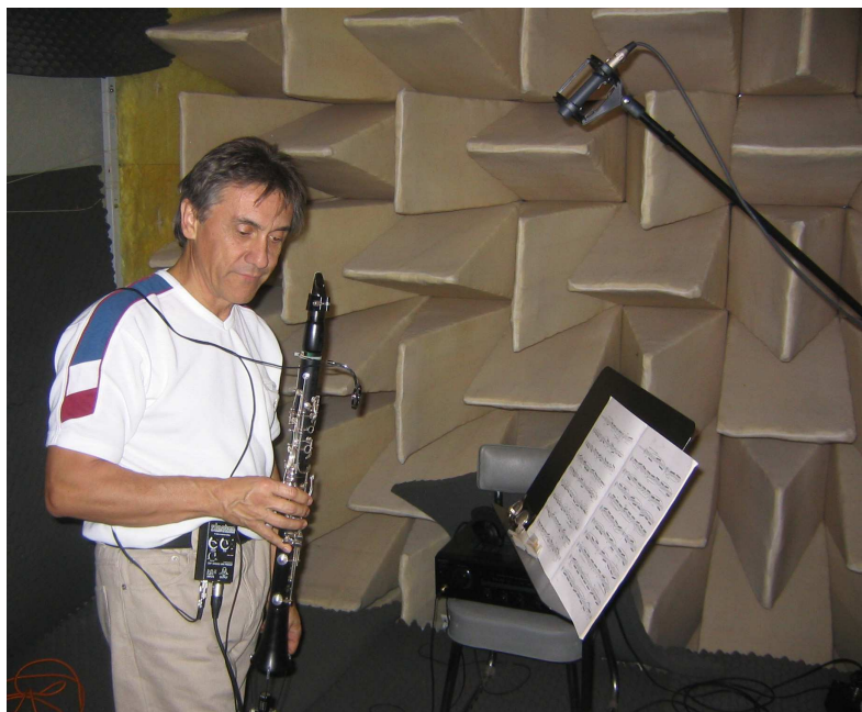
FIG. 5.3 – Enregistrement de séquences musicales de clarinette en chambre anéchoïque. Deux types de microphones ont été utilisés, un système de microphones fixés sur le corps de l'instrument ( SD Systems LCM 82 ), et un microphone en champ semi-lointain ( Neumann KM 183 ).
